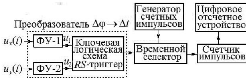
Рисунок 1.10 – Структурная схема цифрового фазометра
