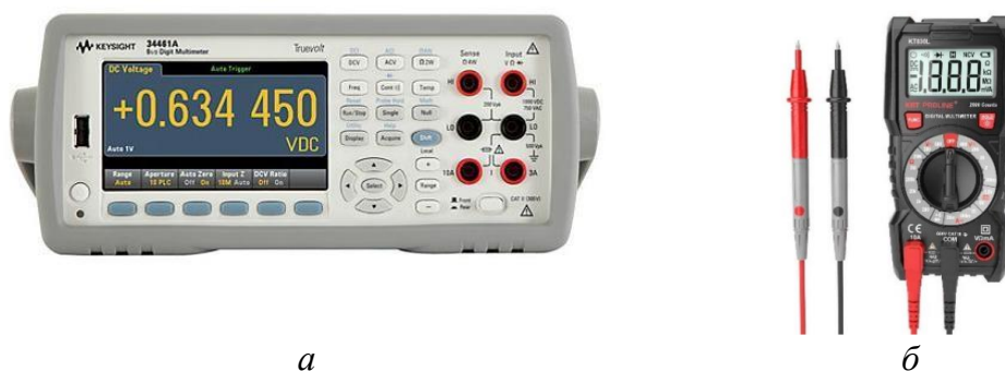
Рисунок 1.1 – Цифровые мультиметры a – стационарный вид, б – портативный вид
