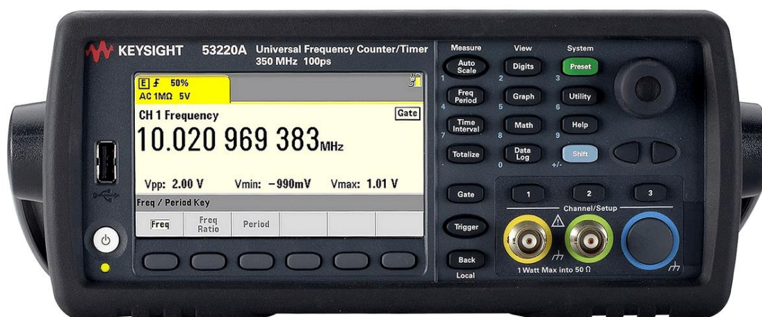
Рисунок 2.7 – Цифровой частотомер Agilent 53220A
